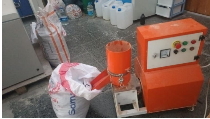
Resim 23. Çalışmada kullanılan 3 kw peletleme makinası
